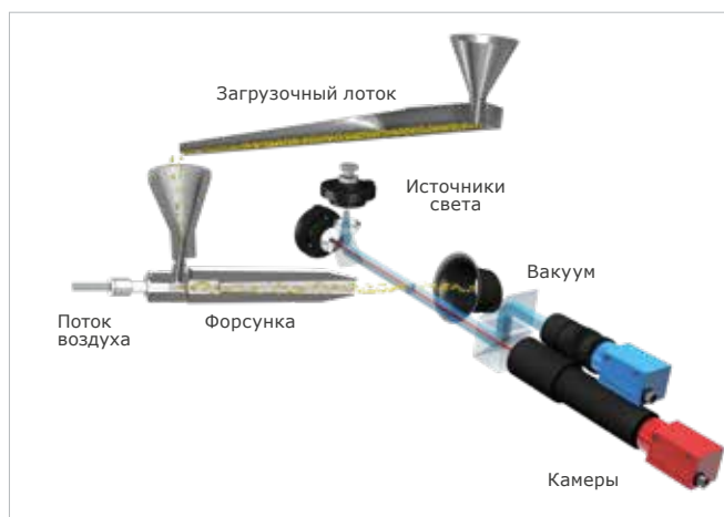
Рис. 3: Уникальный принцип измерения CAMSIZER X2 для анализа сухих порошков.
