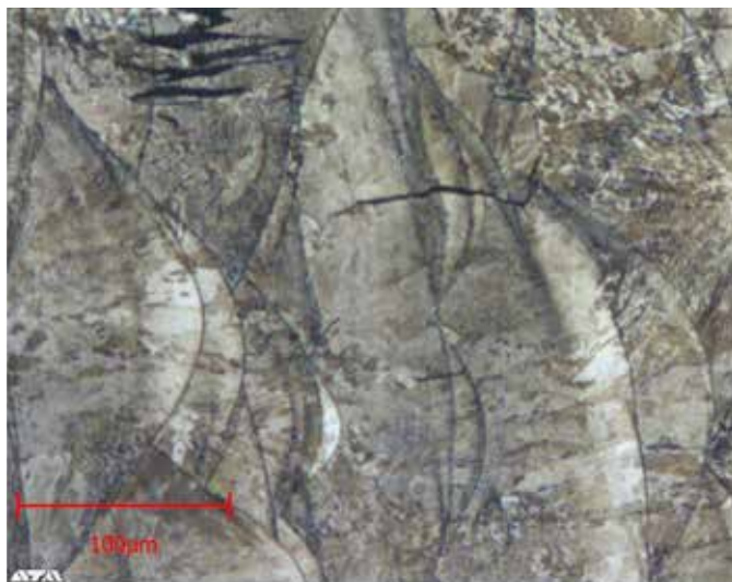
Рис. 8: Изображение образца высокой контрастности. Микроструктура сварного шва четко различима.
