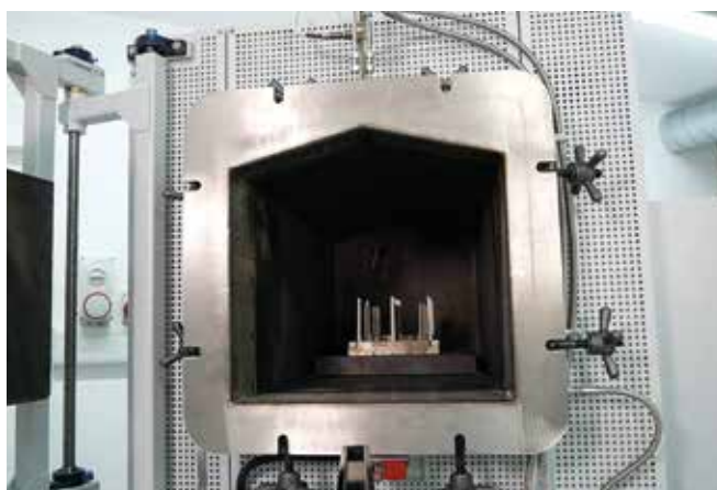
Рис. 2: Металлическая реторта печи GPCMA/174 с изделием, изготовленным с применением аддитивных технологий, используемая для снятия внутренних напряжений
