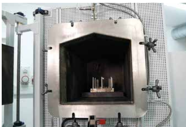
Abb. 2: Blick in eine Metallretorte des GPCMA/174 mit additiv gefertigter Probe zum Spannungsarmglühen.
