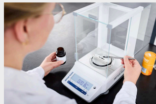
ステップ2：サンプル重量の測定と助燃剤の追加
