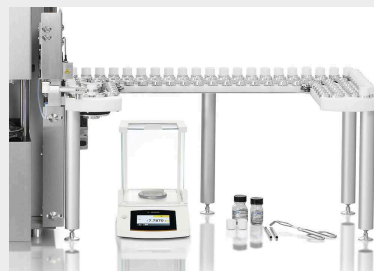
Autoloader cu 130 de poziții pentru creuzete
