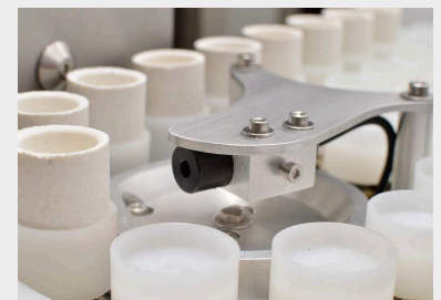
Autoloader cu suporturi pentru creuzete din plastic rezistent la acizi
