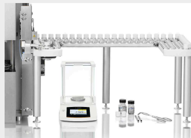
Autoloader cu 130 de poziții pentru creuzete
