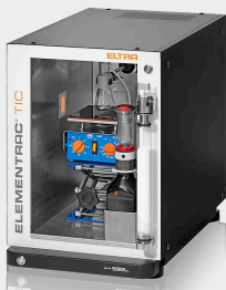
Analizor cu modul TIC opțional
