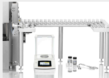
Autoloader con 130 posiciones para crisoles
