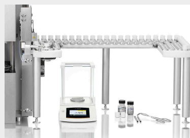
Chargeur automatique comprenant 130 positions de creuset
