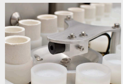
Autoloader mit Tiegelträgern aus säureresistentem Kunststoff
