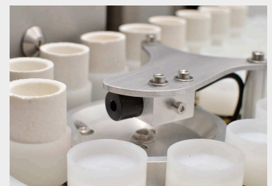
Autoloader mit Tiegelträgern aus säureresistentem Kunststoff
