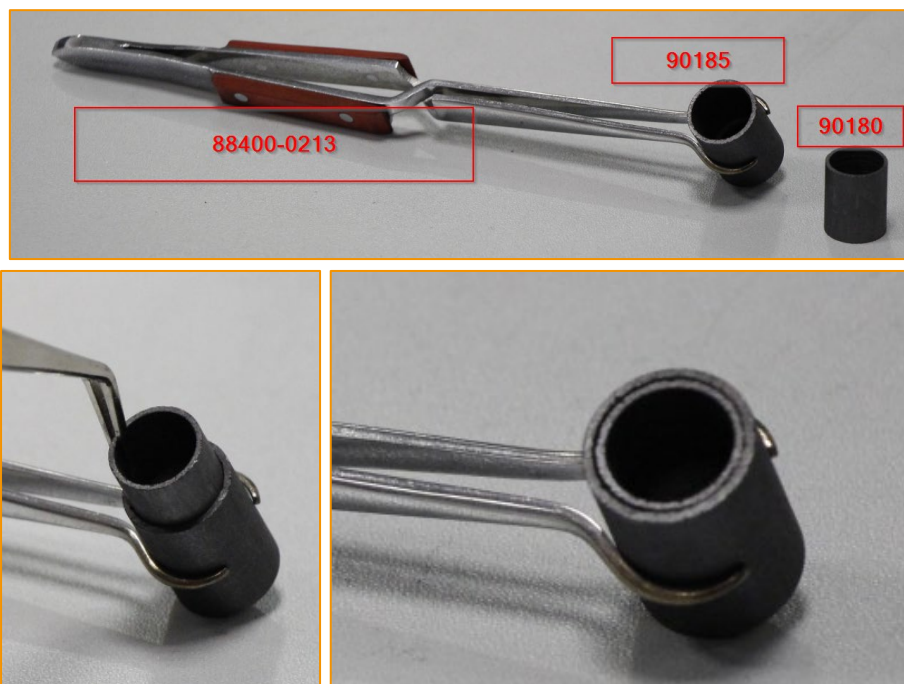
Illustration der Verwendung von innerem und äußerem Tiegel
