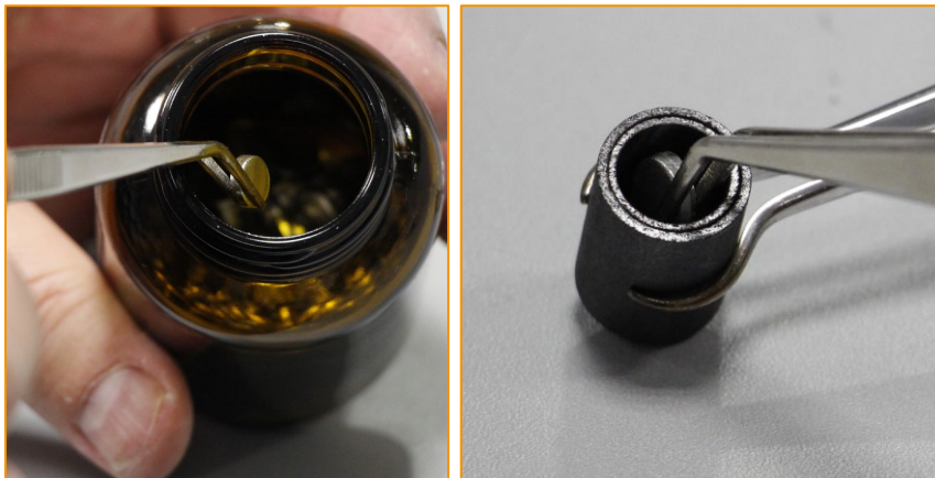
Eintragen von Zinnplättchen in einen Graphit-Tiegel (H in Titananalyse)
