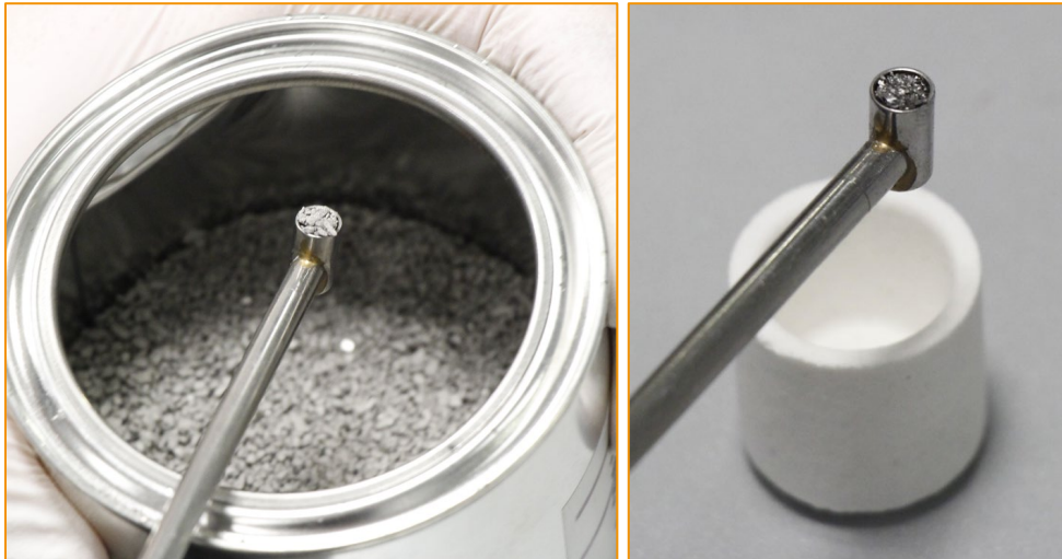
Anwendung von Wolfram mit Löffel (Teilenummer 23113)
