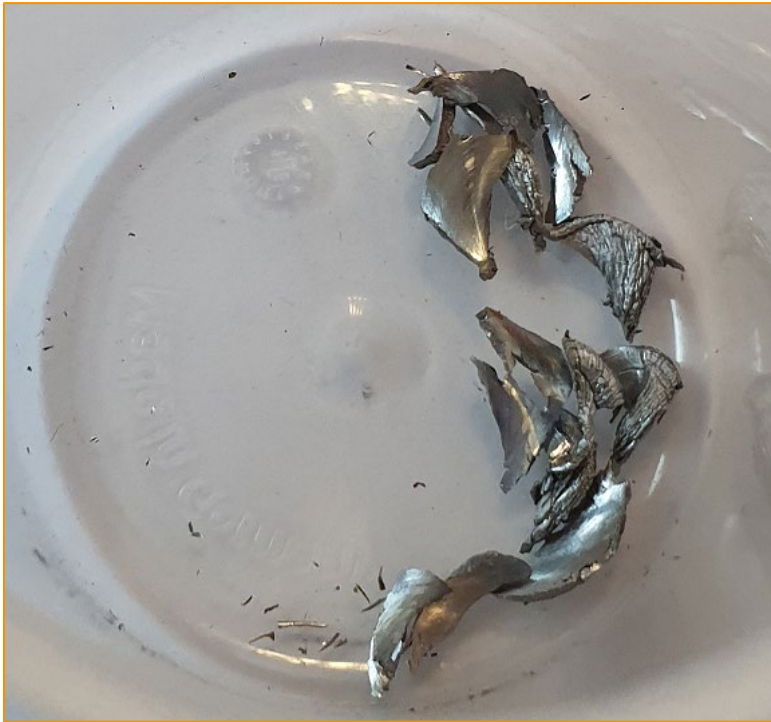
Illustration einer kritischen Probenform: Möglicherweise nicht anwendbar in Ofen und Tiegel
