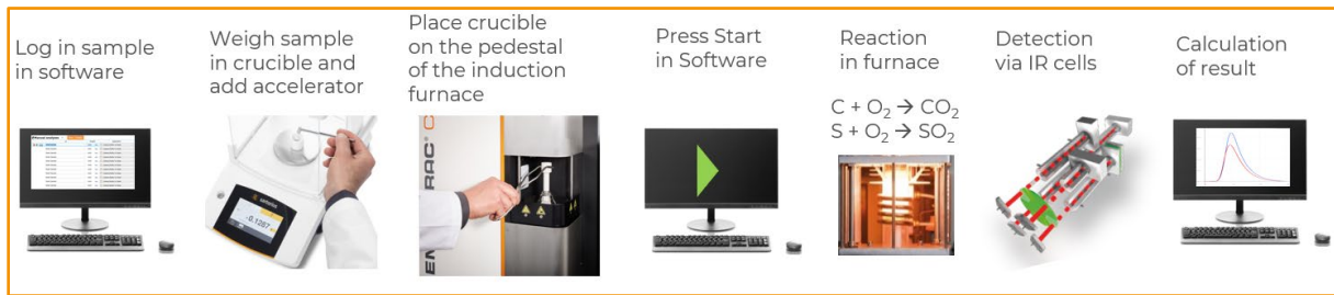
Illustration einer C/S-Analyse mit dem ELEMENTRAC CS-i
