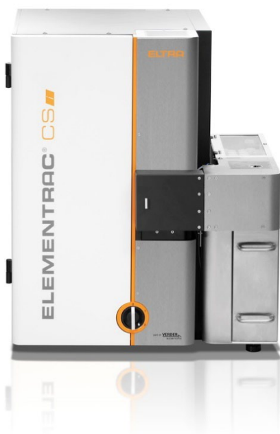
ELEMENTRAC CS-i mit optionalem 36-Positionen-Autoloader
