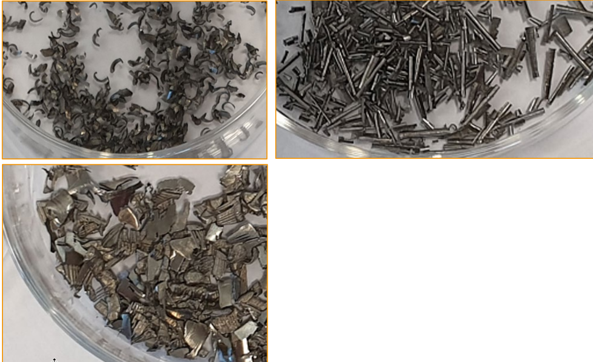
Beispiele für unterschiedlich geformte Proben: Prüfung des anwendbaren Probengewichts erforderlich
