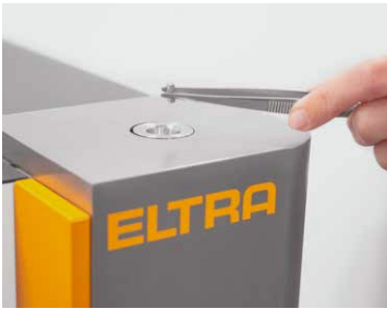
Abbildung 4: Aufgabe einer pulverisierten Probe in einer Nickelkapsel
