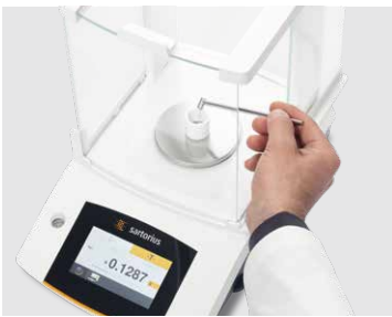
Abbildung 5: Aufgabe des Zuschlags in einen Tiegel mit Probe
