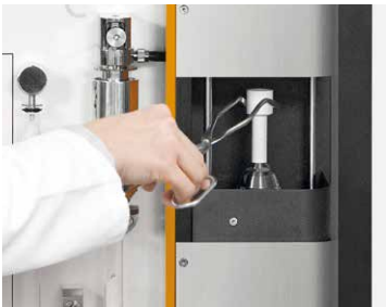
Abbildung 6: Aufgabe einer vorbereiteten Probe in das CS-i-Analysegerät
